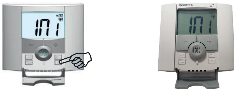
Dès que le récepteur accepte l'appairage le thermostat revient automatiquement à l'écran principal. Le voyant D en orange clignotant du récepteur s'éteint.
