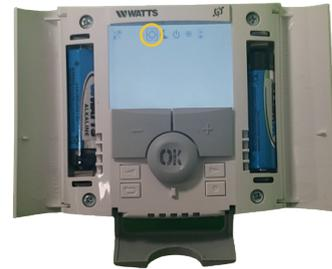
Conseil : Selon la température ambiante du local où est positionnée le Multiwindv2-rev, choisir une température de consigne exagérée, ex : 30°C pour le mode chaud et 10°C pour le mode froid. De la sorte, la demande ne s'arrêtera pas durant la période de mise en service.
