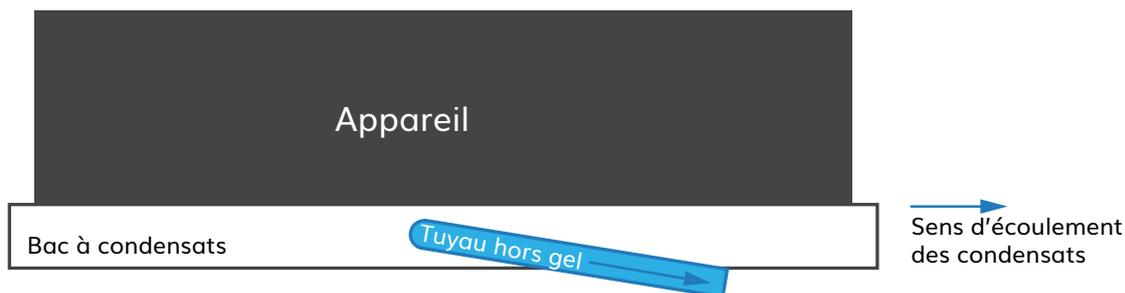
Si l'écoulement gravitaire est insuffisant, une pompe de relevage est nécessaire (matériel non fourni).
