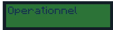
Affichage au démarrage du Multiwindv2-rev si aucun dysfonctionnement n'est détecté
